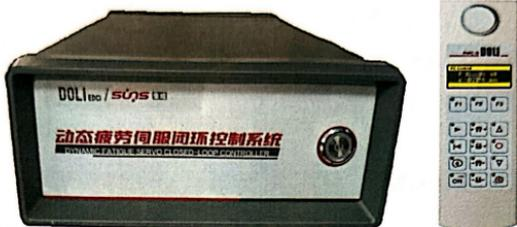
EDCi，是一款功能强大、具有低成本的，尤其是专为数据采集和检测仪器的闭环控制系统。Doli 公司推出的全数字控制系统 EDCi 是功能卓越性价比超群的新一代产品；它是材料及结构试验机的全闭环控制和数据采集的专用电子系统。新的 EDC 控制系统取代原有的 EDC580 和 EDC220。在硬件和系统软件方面有全方位的加强，但同时又保持和先期产品的兼容性。EDCi 则侧重于从复杂的静态试验到常规的一二十赫兹的动态试验直至 250 赫兹的高频动态试验应用。EDCi 主要是作为桌面式独立系统来使用。在采用安装附件后，也可以将它们安置在多系统立式控制柜内或者直接安装在试验机上。EDCi 适用于动静材料万能试验机，有五个 14 扩展槽。适用于：电拉机器， $\pm 250,000$  码载荷通道，位移通道， $\pm 10V$  控制通道。
